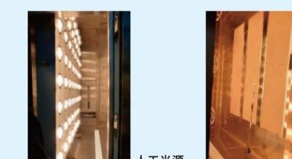
試験方法：人工光源を試験体に照射し、壁構成材の各温度と通過熱量を測定。また、通気構法の試験体においては通気風速を変えても試験を実施。
